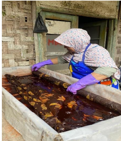
Gambar 5. Pencelupan dilakukan sebanyak 5 10 sampai 15 kali hingga warna yang dihasilkan sesuai.
